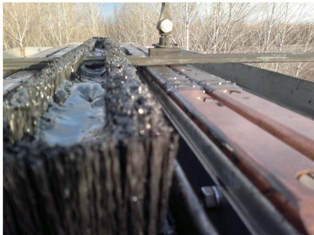
Lubricación del Hilo conductor en movimiento (60 Km/h)
