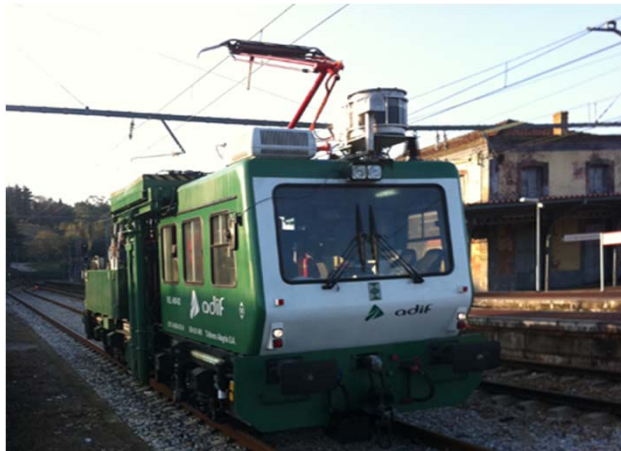
Vagoneta de mantenimiento, con COPLALUBER instalado
