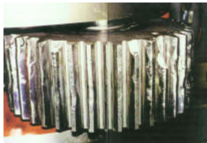
Corona dentada con lubricación deficiente
