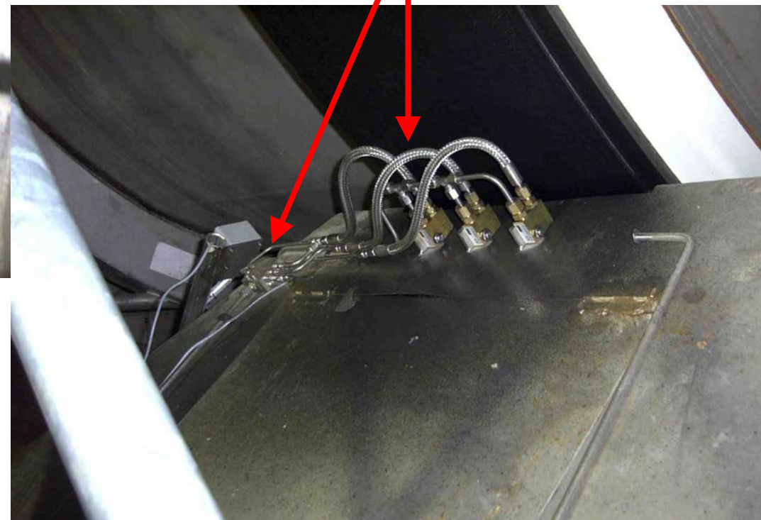
Dosificador de línea doble dispuesto en zona preparación de pastas (Molino astillas)
