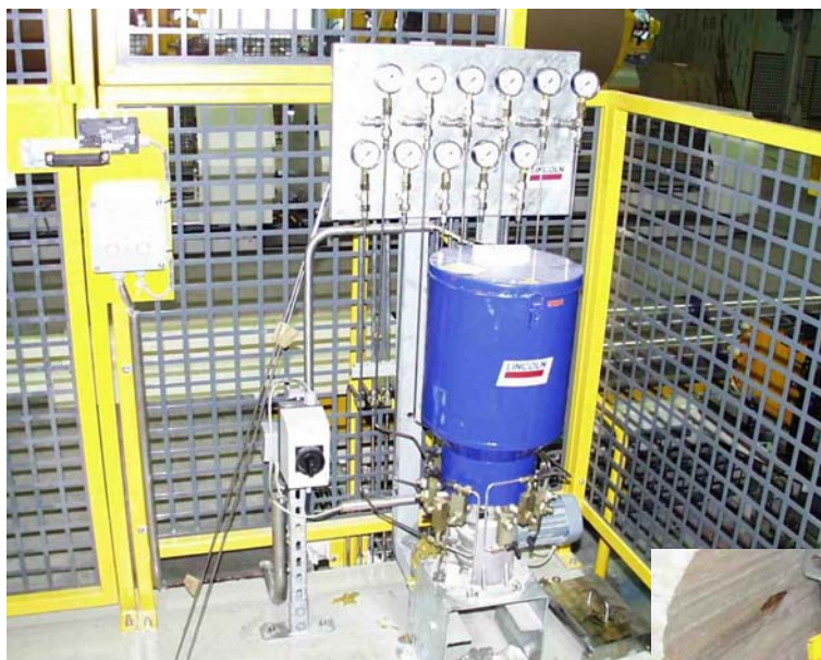
Multilínea-CLS para bobinadora (110 puntos de grasa, aprox.)
