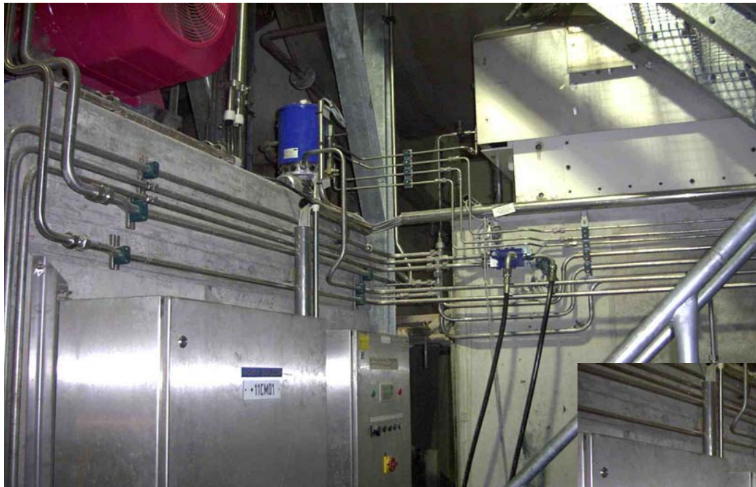
Línea doble - CLS: Equipo bombeo para secadores
