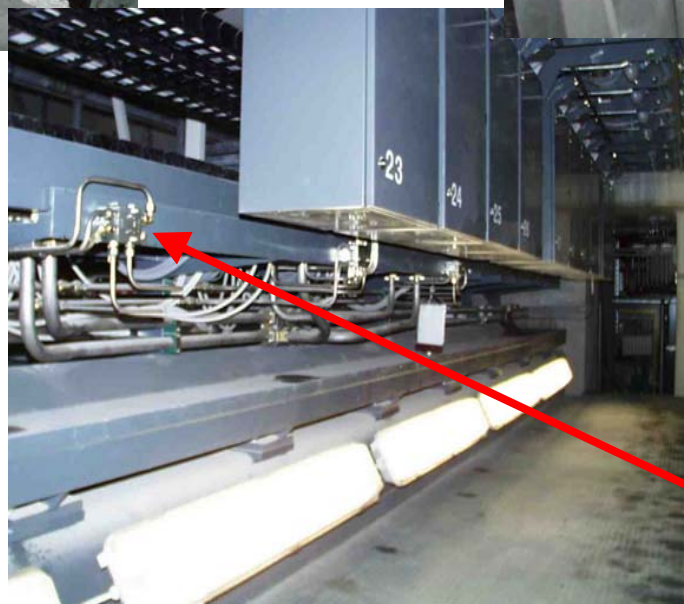
Estación de bombeo para guillotina Zona seca / Zona húmeda (La LISA está aparte)
